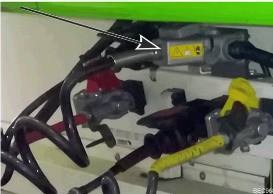
4. Coloque el interruptor M0A en la posición "0".
